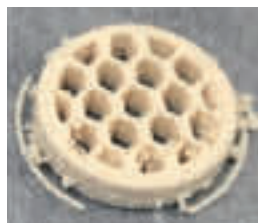
Gepresstes Profil aus Kurzfaser Flachs/Sisal mit Pilzmyzelmatrix
