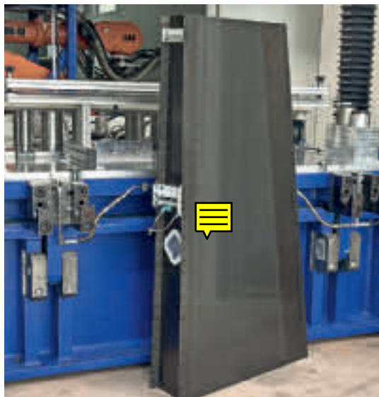
Seitenruder-Ab-schnittsdemonstrator mit thermoplastischen Sandwich-schalen
