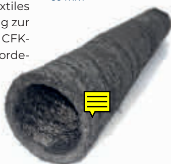
Rundvernadelte Preform aus Carbonfaservliesstoff, Innendurchmesser 60 mm
